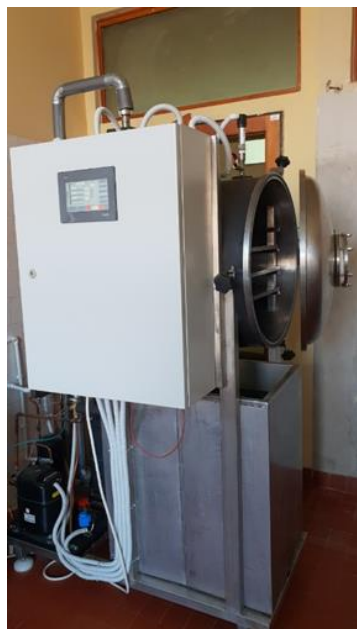
Слика 1. Вакуумска сушара са ејекторским системом
